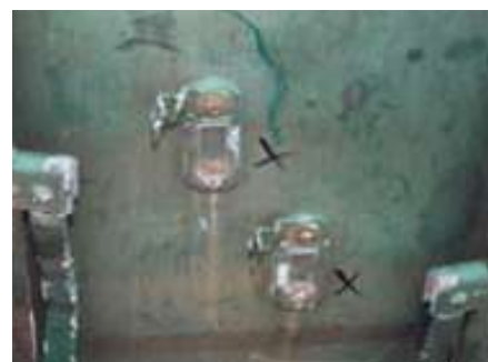
6 Bent door handle/linkage lever.
